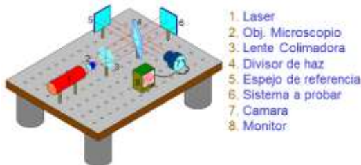
Figura 3. Interferómetro Twyman-Green
